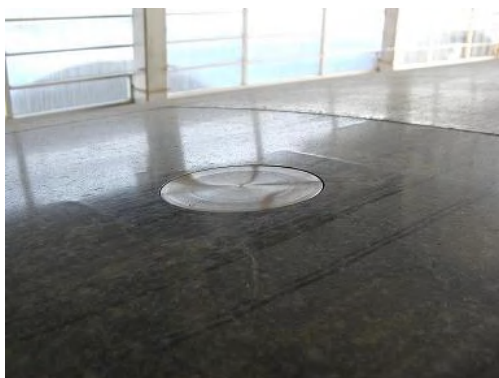
圧力センサー(型枠表面)
