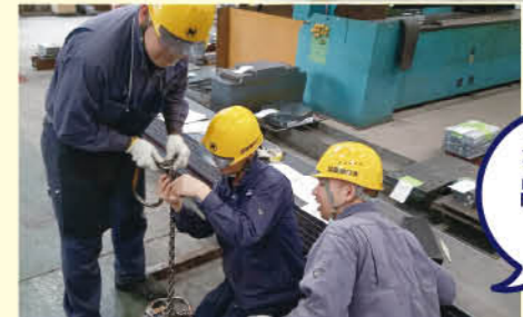
北陸鋼材 吊り具点検
